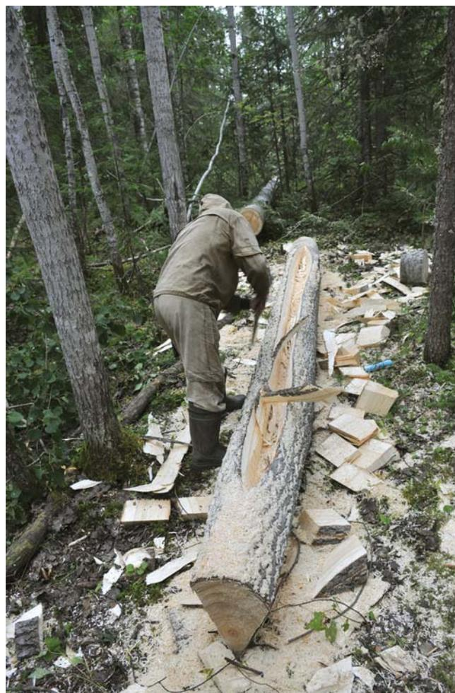
Рис. 2. Черновая выемка древесины из будущей внутренней части лодки и снятие коры (2 этап).
