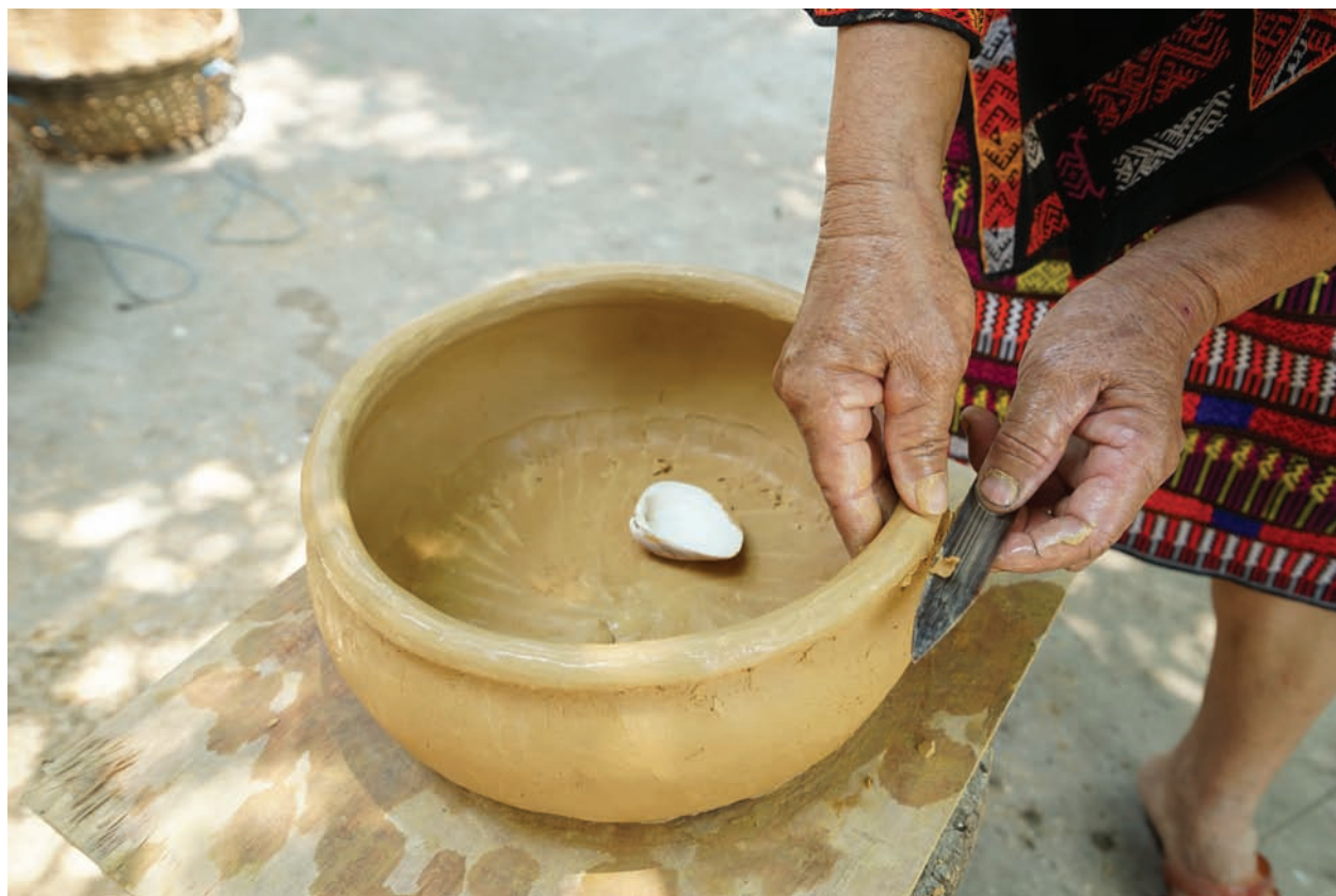
Рис. 3. Обработка поверхности изделия традиционными орудиями – бамбуковым ножиком и морскими раковинами. Фото О.В. Кардаша.
